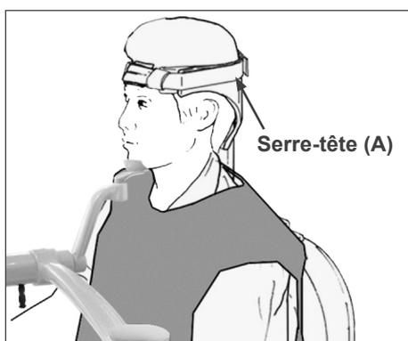
Fixez le serre-tête à l'aide de la bande Velcro ; ne le serrez pas trop. Placez les 2 coussinets du serre-tête, appliqués contre les tempes, comme indiqué dans l'illustration.
