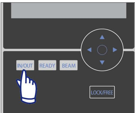
Vérifiez que seul l'opérateur se tient à proximité de l'appareil et appuyez sur la touche Entrée/Sortie patient. « SIÈGE EN MOUVEMENT » s'affiche sur l'écran LCD : le siège et le bras se mettent en position pour l'entrée du patient.
