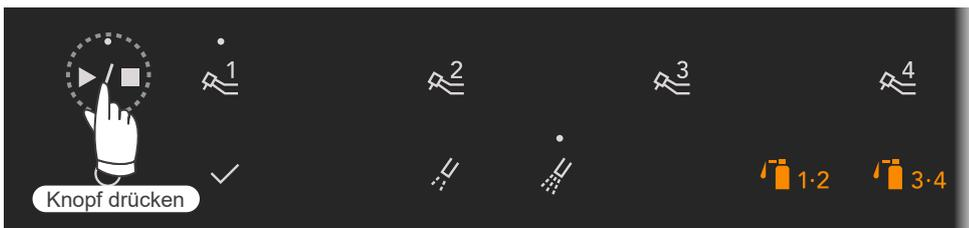
4. Halten Sie den Start/Stop-Schalter etwa zwei Sekunden lang gedrückt, bis Sie zwei kurze Signaltöne hören. Die Leuchte hört auf zu blinken und leuchtet jetzt durchgängig. Die Einstellung ist damit abgeschlossen.
