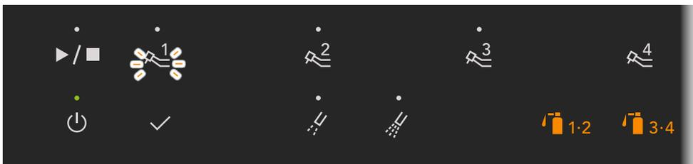
4. Während der Spülmodus läuft, leuchten die Betriebsleuchte und beide Modus-Auswahlleuchten auf. Außerdem blinkt die Sprühschlauch-Auswahlleuchte des gerade gespülten Schlauchs.
