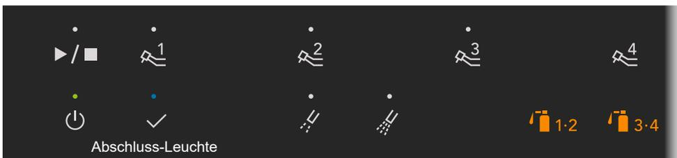
5. Wenn der Spülmodus für alle ausgewählten Sprühschläuche abgeschlossen ist, hören Sie einen einzelnen langen Signalton und die Sprühschlauch-Auswahlleuchte für die entsprechenden Schläuche sowie die Abschluss-Leuchte leuchten auf.
