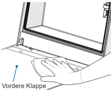
2. Entfernen Sie die Öl-Saugmatte der Klappe und den Mattenhalter der vorderen Klappe und reinigen Sie die Innenseite der vorderen Klappe genauso wie die Geräteoberfläche.
