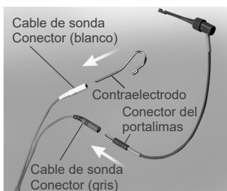
2. Introduzca el conector macho gris del portalimas en el conector hembra gris del cable de sonda. Introduzca el contraelectrodo en el conector hembra blanco del cable de sonda.
