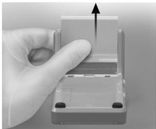
1. Deslice la tapa en la dirección de la flecha que aparece en la imagen y sáquela del Root ZX mini.
