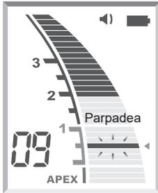
La posición de la punta de la lima se muestra en la pantalla mediante la barra del indicador de la longitud del conducto. La barra intermitente parpadea cuando se introduce la lima en el conducto radicular.
