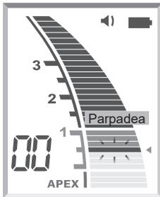
Una lectura del medidor de 0,5 indica que la punta de la lima se encuentra en la constricción apical o muy cerca de la misma.
