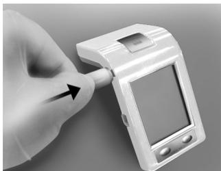
1. Introduzca el conector del cable de sonda totalmente en el conector hembra que se encuentra a la izquierda del Root ZX mini.
