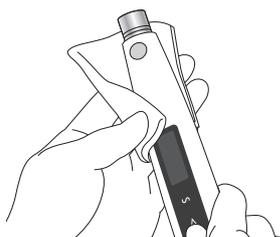
Limpe los componentes con una gasa humedecida con etanol (vol. 70–80%) bien escurrida.
