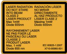
Etiqueta de precaución por radiación láser (solo para EX-1)
