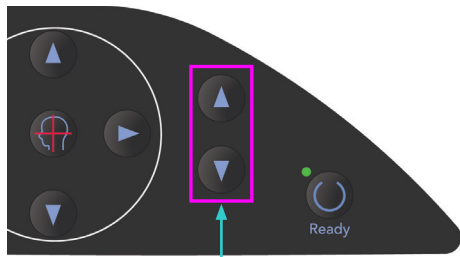
Клавіші пересування підйомника вгору й униз
